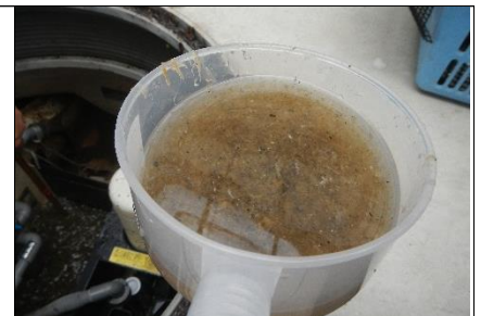
逆洗後の接触ろ床槽内水の様子
