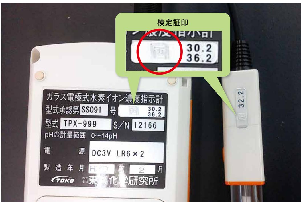
※1 特定計量器の「構造」と「器差」について、検定検査規則(省令)で定める技術基準への適合性を、国、都道府県などが確認する計量法上の検査のことを言います。これに合格した計量器には、「検定証印」というマークが付されます。
