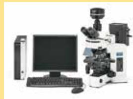
写真の顕微鏡は「微分干涉顕微鏡」といって、生きた微生物を鮮明に観察することができる優れた顕微鏡です。モニターも付いており、顕微鏡を覗かなくてもモニターで微生物の観察ができます。
