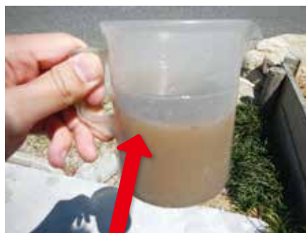
好気循環バルブを全開にした時に、排出した処理水槽底部の汚泥
