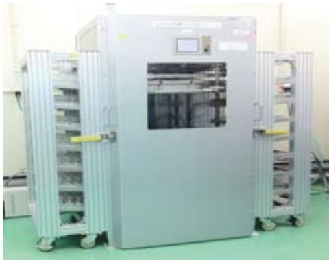
土日対応自動BOD測定装置
