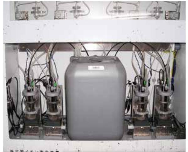
塩化物イオン自動測定装置滴定槽
