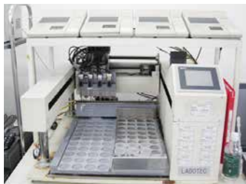
pH自動測定装置(pH計4台組み込み)
