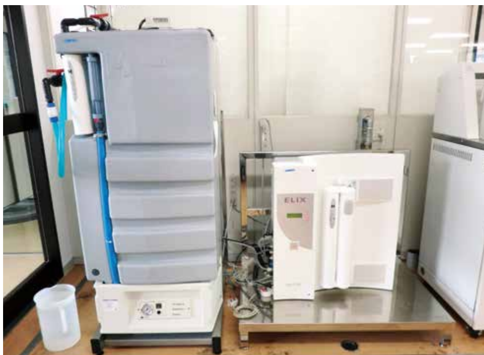
純水製造装置
