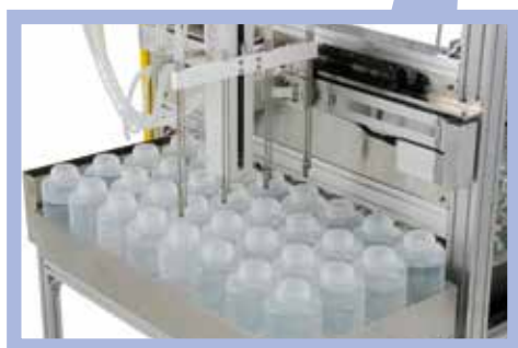
検体容器から試料を自動で採取
